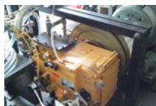
日本で初めてDMEの運転に成功したエンジン
