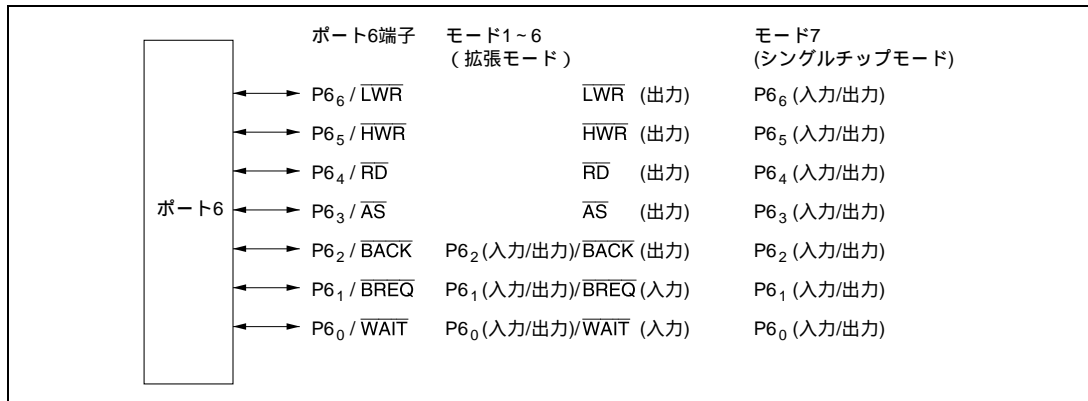
図 9.6 ポート 6 の端子構成
