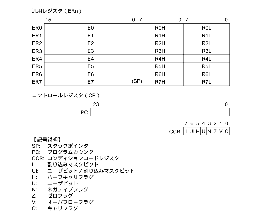
図 2.3 CPU 内部レジスタ構成
